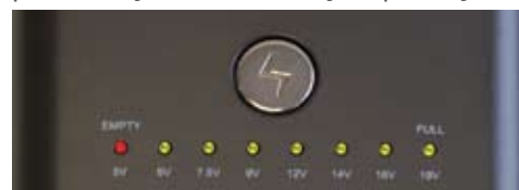
Imagine dedesubt: Șir LED-uri bine organizat pentru afișarea tensiunii și capacității
