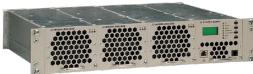
Imagine dreapta: Subrack 19" 2U asamblat din : backplane pentru 3 buc. de invertore INV2xx și 1 buc. comutator static STS207
