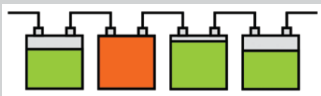
Fig. 2: Metodele tradiționale de încărcare ale bateriilor pot cauza supraîncărcare sau descărcare profundă, eventual deteriorarea individuală a bateriilor, care, la rândul lor compromite fiabilitatea întregului sistem.
